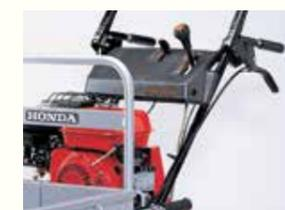
La transmission hydrostatique offre une grande facilité d'utilisation
